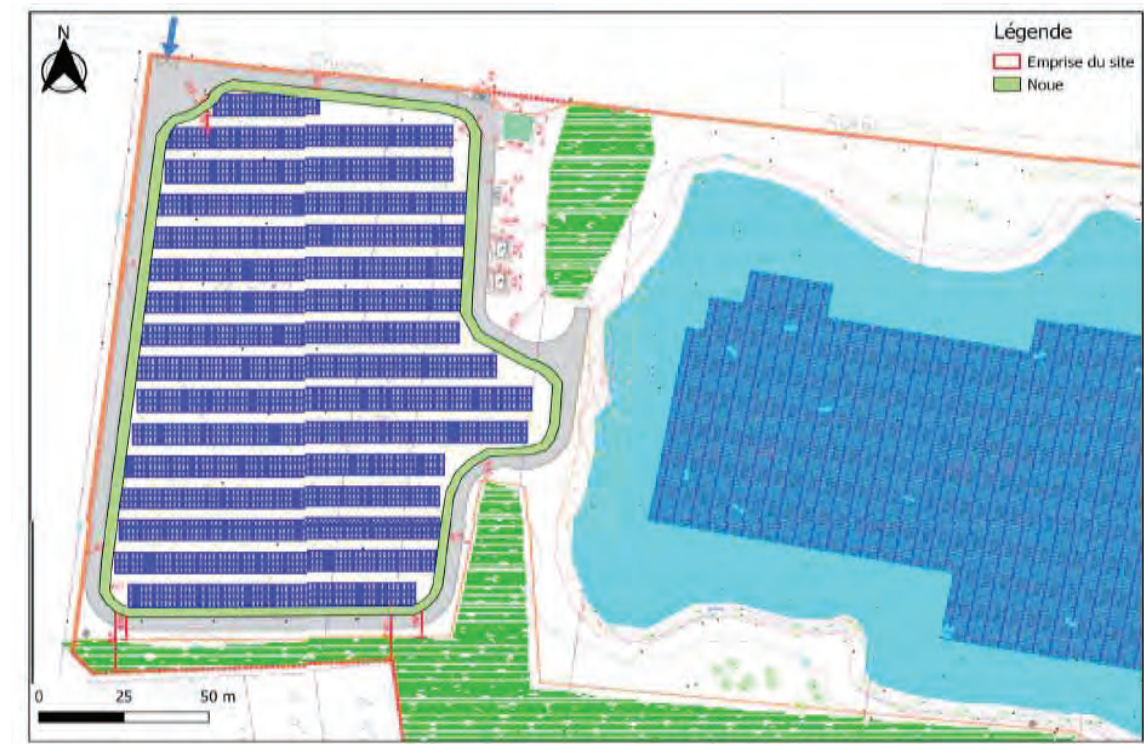
Figure 5 : Positionnement de la noue d'infiltration
